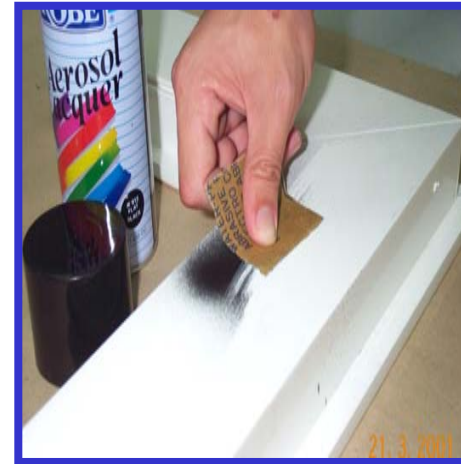
3. ใช้กระดาษทรายชุบน้ำขัดดอย เปื้อนสีเปรี้ยวไปในทิศทาง เดียวกัน
